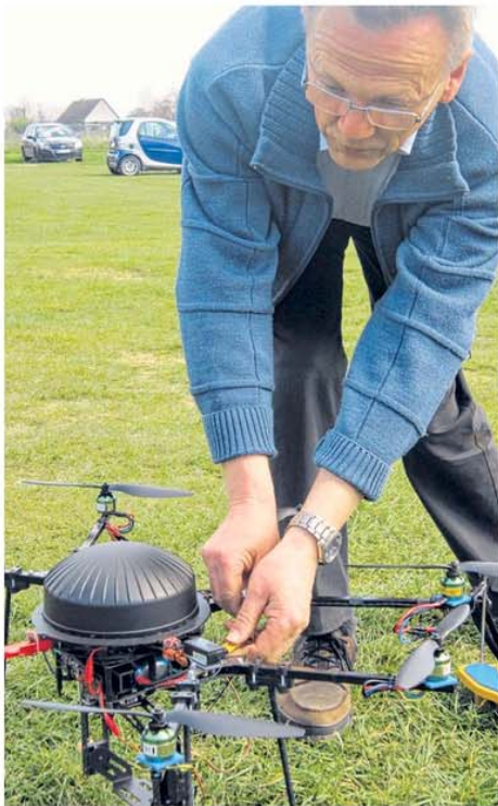
Oktopter nennt sich das Flugobjekt, das der Paserwaker Wolfgang Rodecke selbst entwickelt hat. Acht Rotoren befördern das High-Tech Modell in die Luft, während es vom Boden aus gesteuert wird. Mit einem GPS-System und Kamerahalterung verfügt das Gerät über gewisse Extras. So hat Wolfgang Rodecke mithilfe des Oktopters unter anderem gestochen scharfe Bilder von Pasewalk und Umgebung aus der Luft aufnehmen können.
